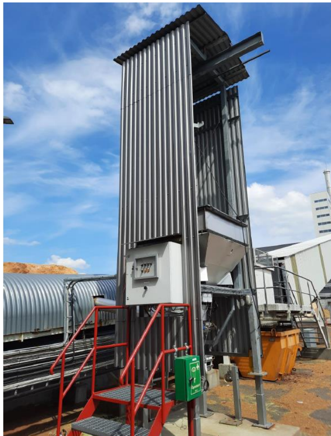
Figur 7 Doseringsstation för svavelgranulat.
