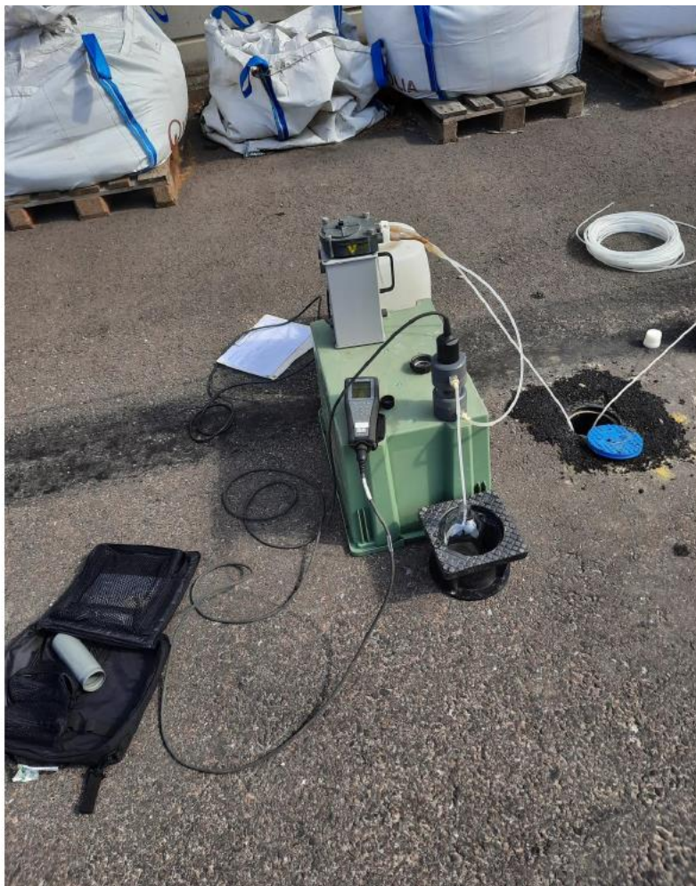
Figur 18 Omsättning och fältmätning i flödescell.
