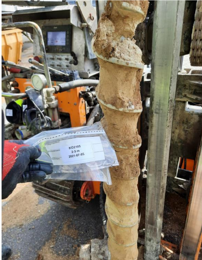
Figur 17 Silt mellan 1 och 2 meter i KÖ2105.
