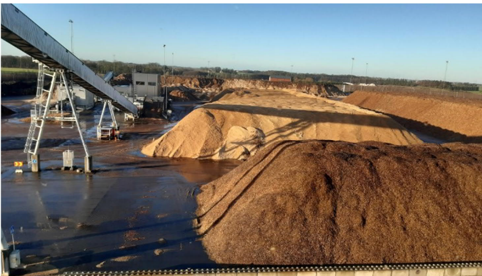
Figur 8 Bränslelagring vid befintlig verksamhet. På bilden syns lagerytan, sållhuset med skivsåll, bandmagneter och rejektkross samt transportbandet till pannan.
